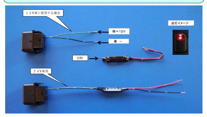
12V車に使用する場合、ハーネス中間の収縮チューブで覆われている基板を切断し、 緑コードを+、黒コードを-アースに接続してください。
