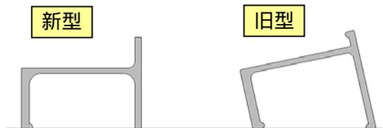
切断作業、穴明け作業の時、設置面と加工面が平行になり、作業性が向上します。
